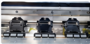
Rodillos de presión ajustables en 3 niveles
